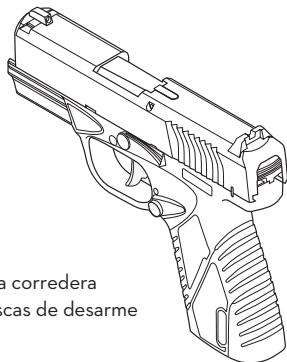
Fig. 9 - con el arma descargada y apuntando en una dirección segura, presionar el disparador
